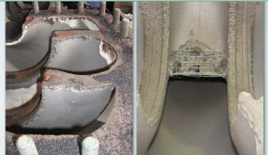
A gödrösödés és az erózió egyértelműen látható
